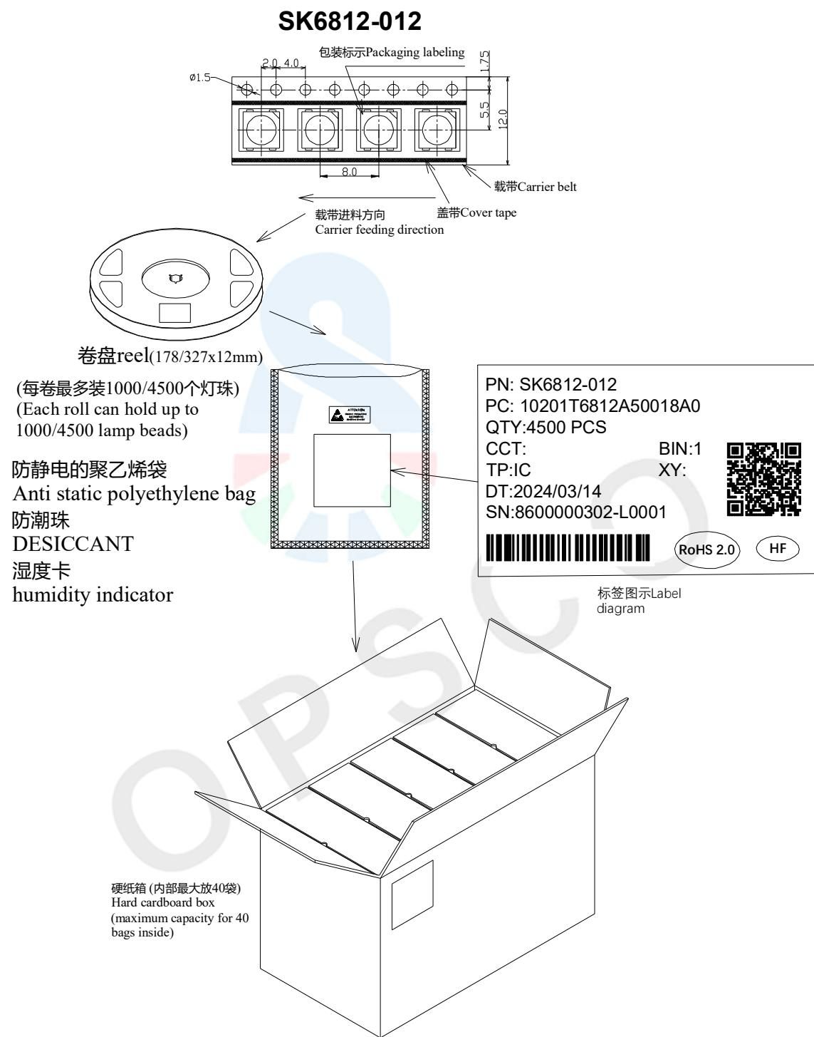
表面贴装LED采用卷盘包装，LED在用普通或防静电袋包装后再装在纸箱中。纸箱用于保护运输途中LED不受机械冲击，纸箱不防水，因此请注意防潮防水。
