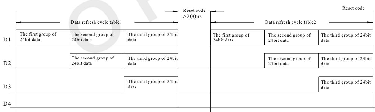
注Note：其中D1为MCU端发送的数据，D2、D3、D4为级联电路自动整形转发的数据。
