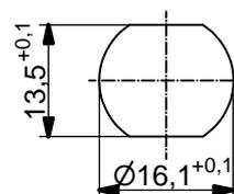
Minimale Wandstärke 1,5mm, alternativ Frontplattenausschnitt d=16,1
