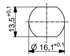
Minimale Wandstärke 1,5mm, alternativ Frontplattenausschnitt d=16,1
